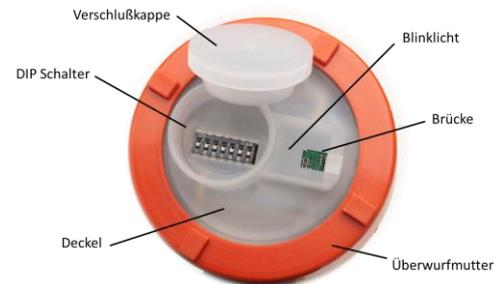
Leiterplatte mit aufgesteckter Brücke nur für 125 cm<sup>3</sup>
