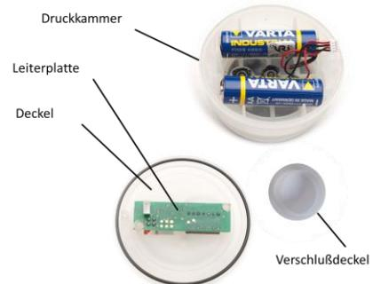
Leiterplatte von Druckkammer abnehmen und auf Deckel montieren
