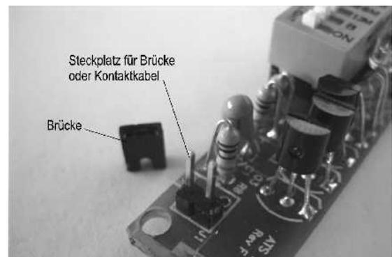
**Achtung:** bei abgezogener Brücke von der Leiterplatte ist die Schmierbüchse nicht funktionsfähig!
