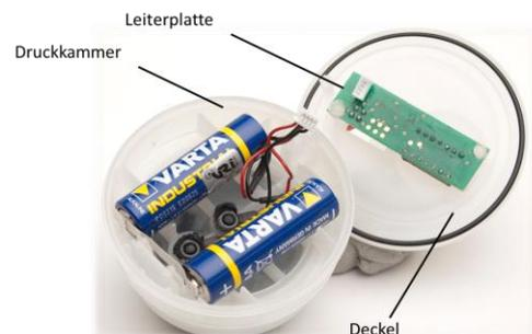
Druckkammer mit aufgesetztem Deckel in die Schmierbüchse einsetzen, dabei auf korrekte Positionierung achten. Nase an der Druckkammer muß in der Kerbe an der Büchse einrasten.
