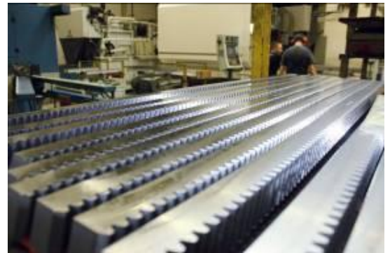
Zahnstangenfertigung im Werk 2 des Weltmarktführers Atlanta.
