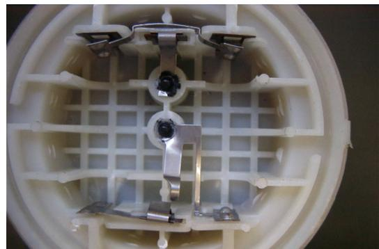
Deckel mit monierter Leiterplatte auf Druckkammer aufsetzen. Dabei darauf achten, dass die Kontaktfläche an der Unterseite der Leiterplatte auf der Kontaktfeder in der Druckkammer aufliegt. Den Deckel leicht andrücken bis die Leiterplatte in der Druckkammer einrastet.
